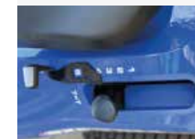
SISTEMA DE MEMORIA DEL AJUSTE DE LA ALTURA DE CORTE (SLE122, opcional en los demás modelos)
