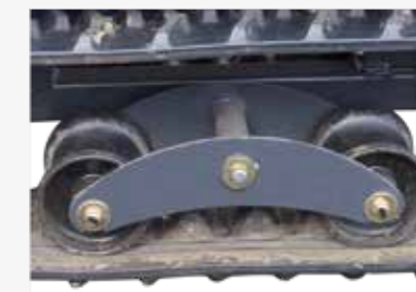
ORUGAS SOBRE MECANISMO DE PÉNDULO
