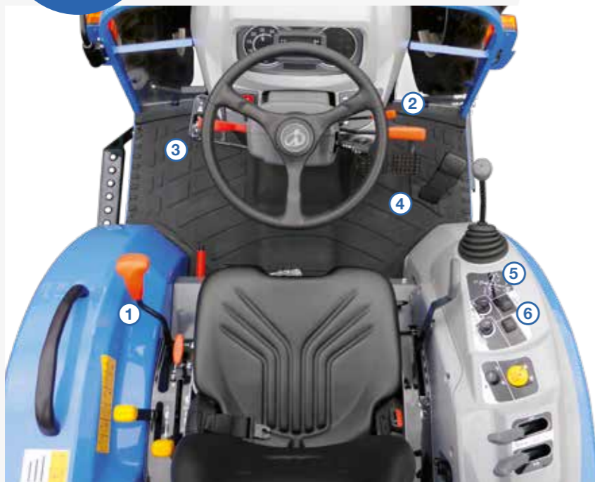
Mando de selección de gama de velocidades (1), mando Hi-Low (2), inversor de marcha (3), pedal de avance (4), regulador de velocidades (5), función de memoria de velocidad para regresar a la velocidad inicial (6).
